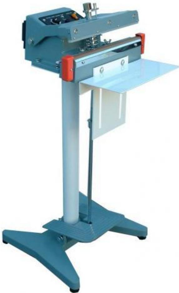
Las Selladoras de pedal **FI** son de gran utilidad para el sellado de bolsas de Polietileno, Polypropileno y casi cualquier material termosellable, cuentan con Timer para regular el tiempo de aplicación de calor y poder así sellar bolsas de diferentes calibres.
